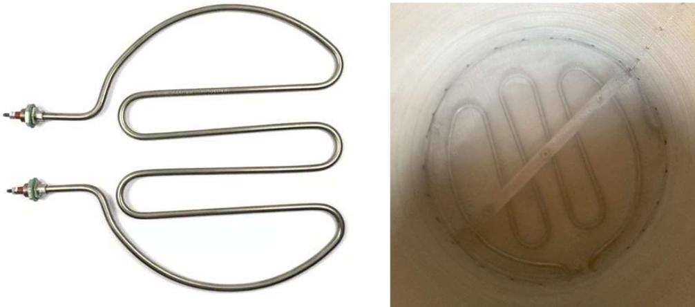
Fervura: Resistência de 4000 Wats, alimentada por tensão de 220V e 18,2<sup>a</sup> de corrente. Essa resistência foi utilizada na panela de fervura sem controle.
