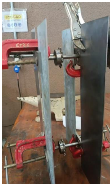
Figura 20: Estrutura do elevador de canecas. FONTE: Arquivo pessoal.
