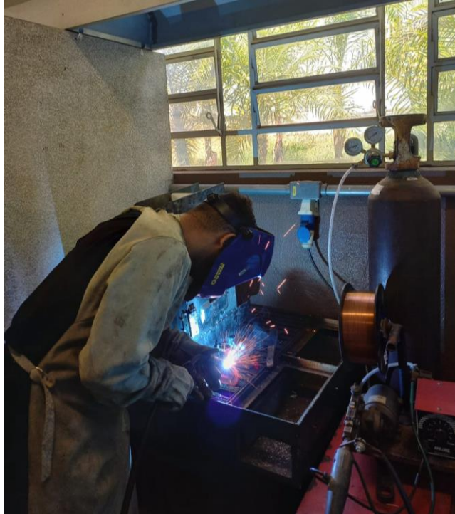
Figura 21: Aluno soldando a estrutura do protótipo FONTE: Arquivo pessoal
