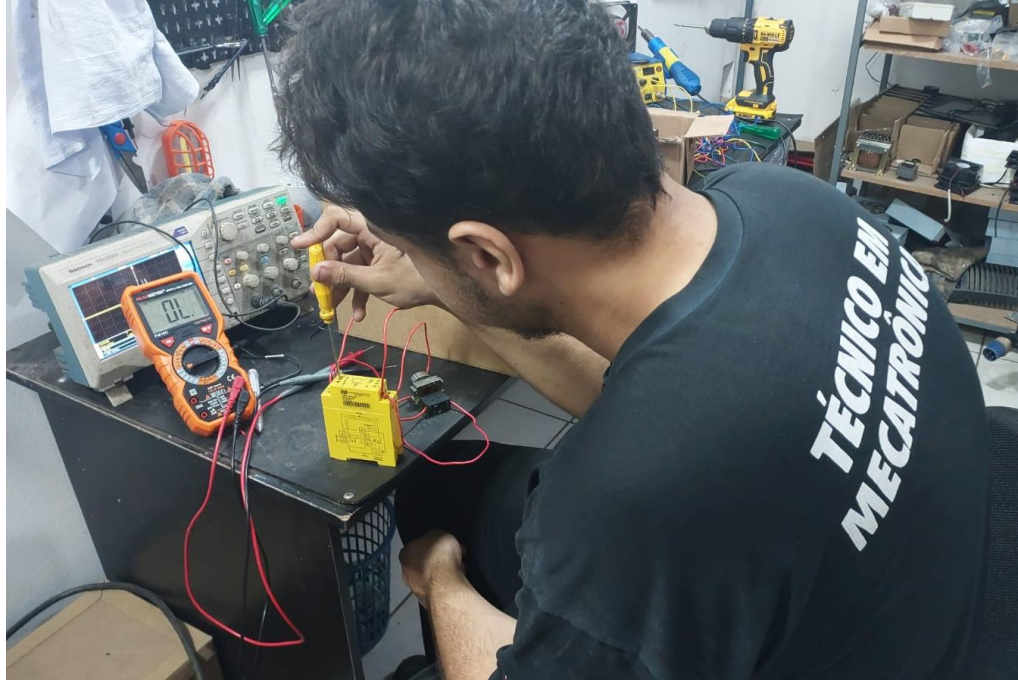
Figura 27: Aluno realizando teste com auxílio de um potenciômetro no relé FONTE: Arquivo pessoal
