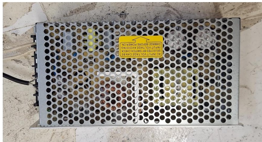
Figura 16: Fonte 24V (volts) 6,5 (amperes) FONTE: Arquivo pessoal
