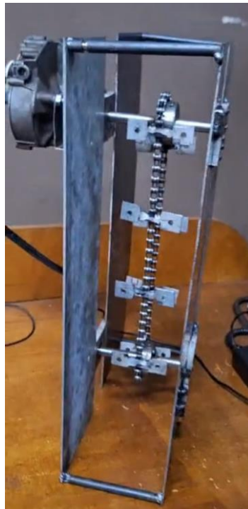
Figura 22: Corrente com as chapas de canecas soldadas FONTE: Arquivo pessoal.
