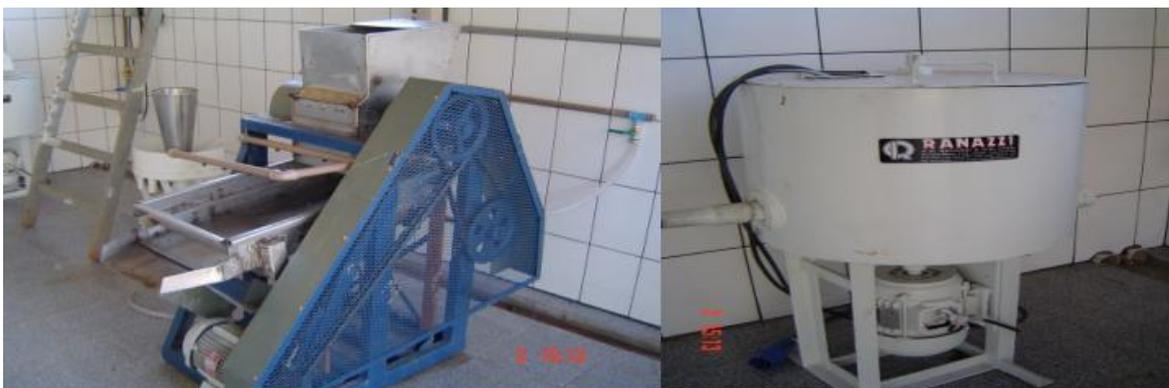
Com as raízes já trituradas, são passadas em uma peneira com orifício de 1 mm para eliminação da água para serem prensadas em prensa hidráulica com capacidade de prensagem de 15 T, esse processo é realizado manualmente. Atingido o peso ideal, a farinha permanece na prensa por 3 minutos, a capacidade da presa é de 5 Kg por vez.
