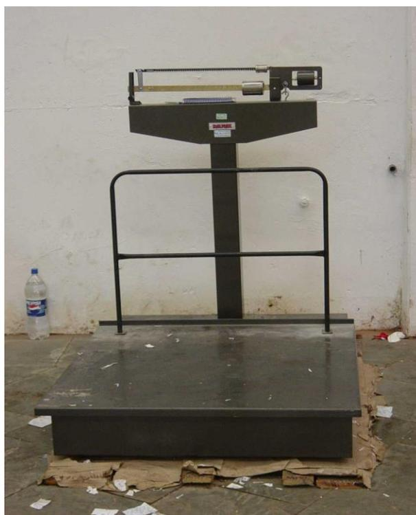
**Figura 10 – Balança Mecânica**
