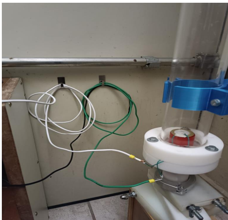
Figura 70 – Exposição do sensor piezoelétrico anexado ao arranjo.
