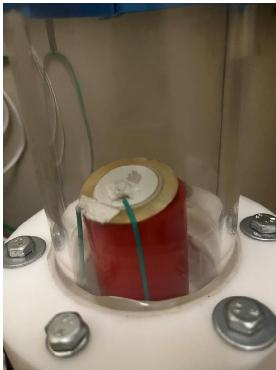
Figura 64 – Sensor piezoelétrico, danificado após a série impactos.
