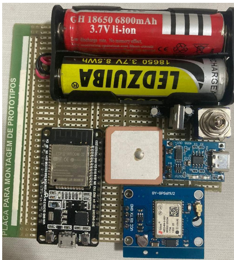
Figura 20: Montagem do Circuito do Protótipo na fenolite FONTE: Próprios autores
