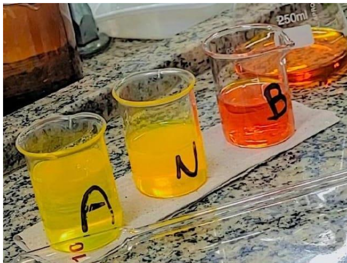
Figura 9: Indicador à base de curcumina em meio ácido, neutro e básico
