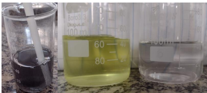
Figura 1 – Teste de adsorção utilizando carvão ativado
