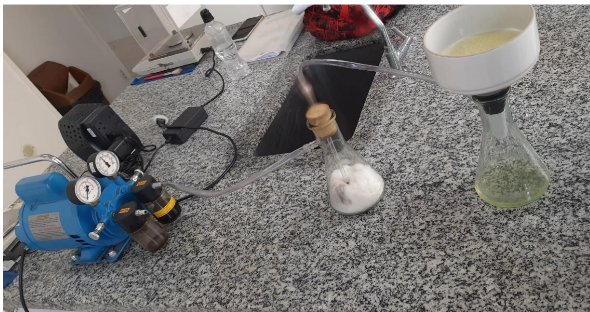
Figura 10: Pectina precipitada em processo de filtração a vácuo.
