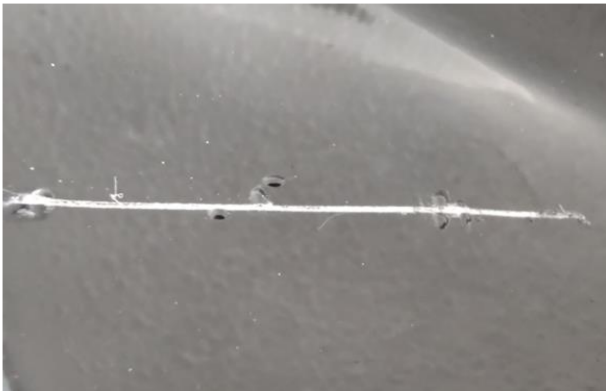
Imagem 3: Amostra preta após período de exposição ao CASS test
