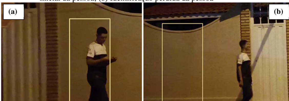
Figura 3 – Abordagem de Identificação com o algoritmo MedianFlow: (a) Identificação inicial da pessoa; (b) Identificação perdida da pessoa
