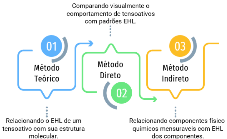
Figura 11- Principais métodos utilizados no sistema EHL
