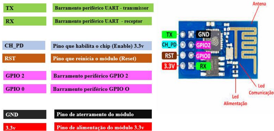
Figura 2 - módulo Wifi ESP8266
