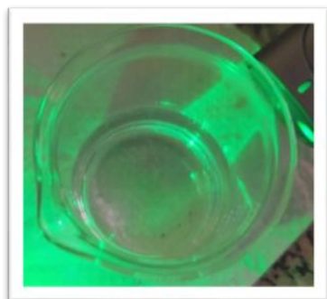
Figura 10: Solução padrão teste Tyndall.
