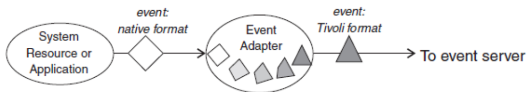
Figura 4: Fluxo de eventos de um adaptador de eventos ( IBM-GUIDE , 2012)
