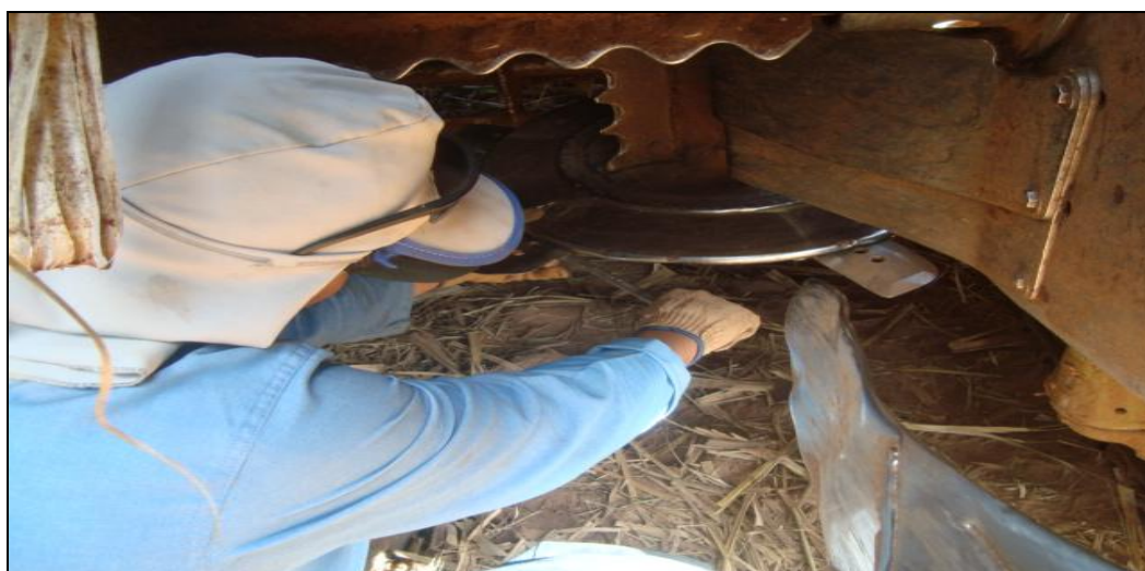
Figura 4- Troca de facas do disco de corte de base.
