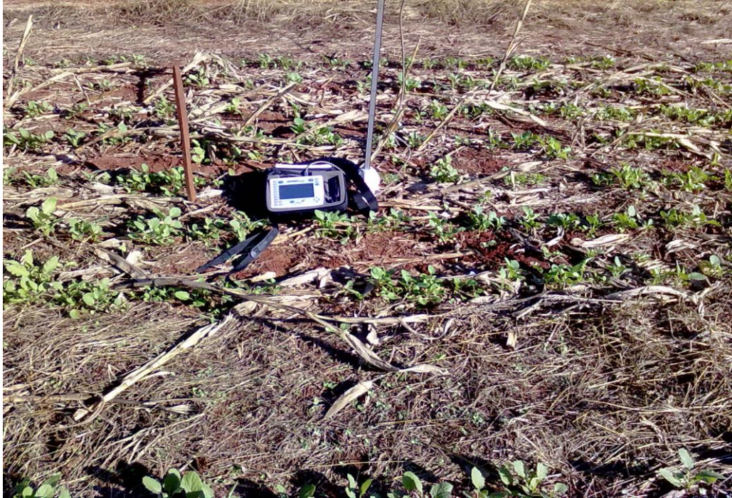
Figura 7 - Equipamento Diviner ® no cultivo de Crambe sobre palha de milho na FCA-UNESP de Botucatu, 2012
