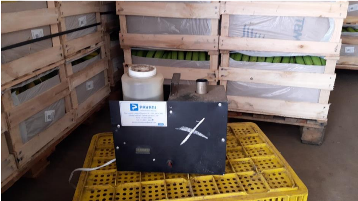
Figura 3: Motor móvel com etileno líquido utilizado dentro da câmara fria
