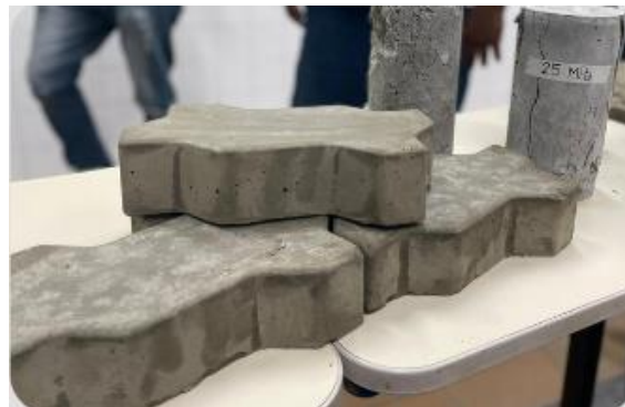
Imagem 10: bloco intertravado com resíduo
