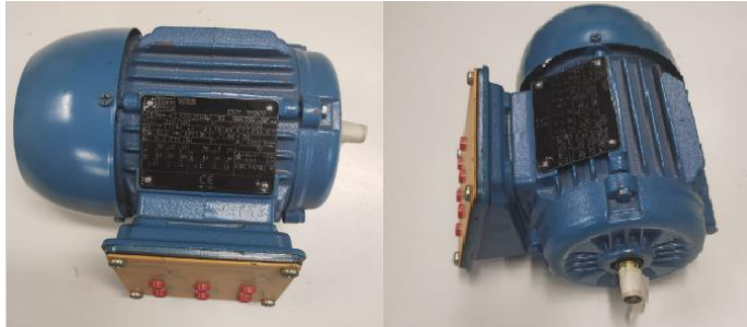
Figura 13 — Motor de Indução Trifásico
