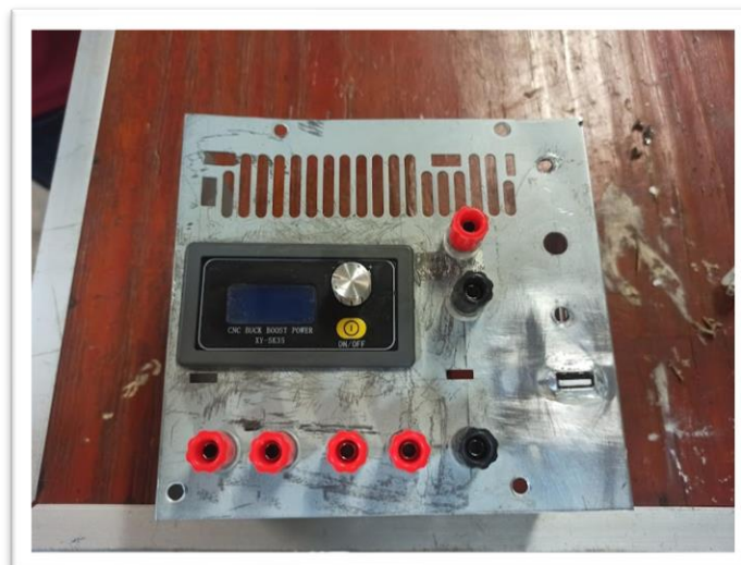
Figura 12 - Furos Realizados na Tampa Da Fonte
