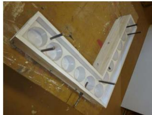
Figuras 4 e 5 – Formas para a moldagem das peças de ligação Retilínea e “L”.
