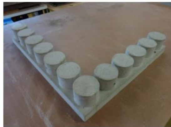
Figuras 8 e 9 – Moldagem de peça de ligação “L”.
