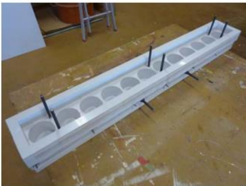
Figuras 4 e 5 – Formas para a moldagem das peças de ligação Retilínea e “L”.
