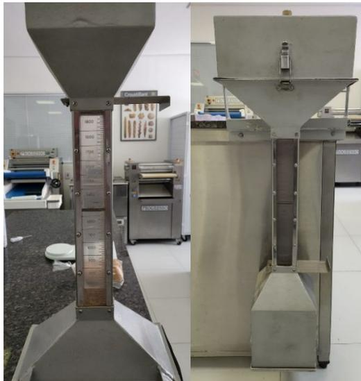
(Figura 6 -Medidor de volume CHOPIN, por deslocamento de semente, modelo MVP1300, Brasil)
