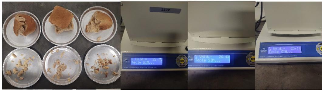
(Figura 11: Teste de umidade em Triplicata)
