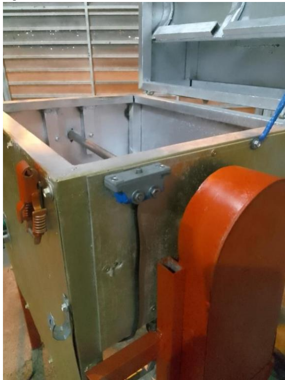
Figura 25: Acionador normal aberto, ao abrir a tampa corta a corrente que alimenta o motor NR12.
