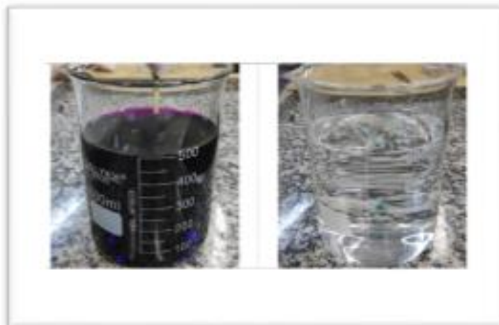
Figura 6 - Resíduo de permanganato de potássio - antes e após o tratamento
