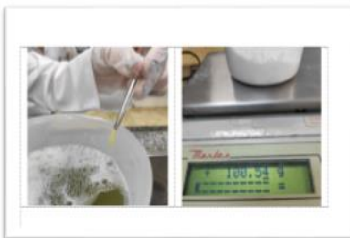
Figura 2 - Verificação do pH da solução e adição de NaOH para ajuste do pH do resíduo
