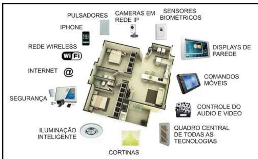
Figura 6 - Sistema pervasivo doméstico. Distribuição de eletrônicos de consumo gerenciados por um dispositivo central (AVC SERVICE 6 ).
