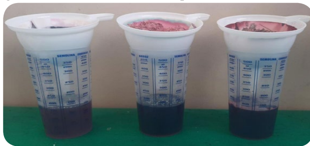
Imagem 3 – Coloração de solução por diferentes adsorventes.
