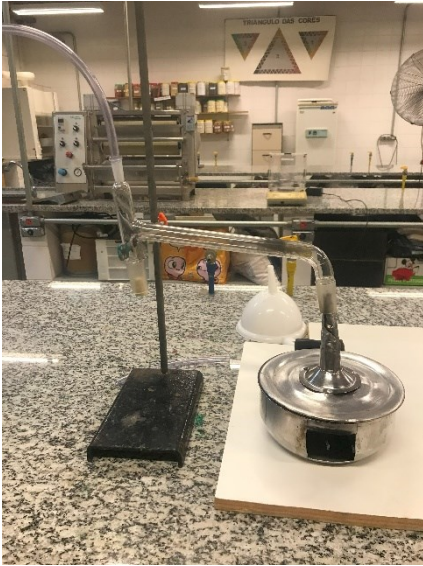
Fotografia 16 – Conexão de vidro com a panela de combustão
