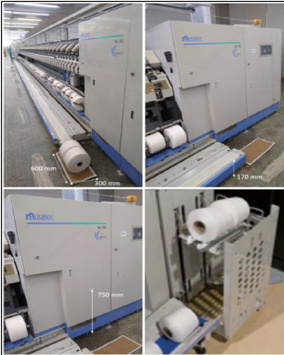
Figura 14 - Elevador em execução no final da esteira
