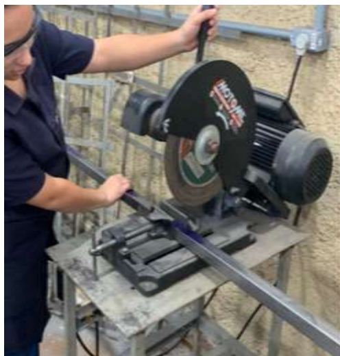
Imagem 13: Corte do metalon utilizado para a estrutura da porta
