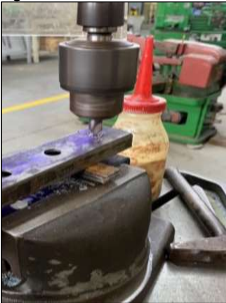
Imagem 14: Furo com broca de centro
