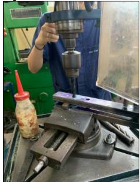
Imagem 15: Furo com broca de 15mm
