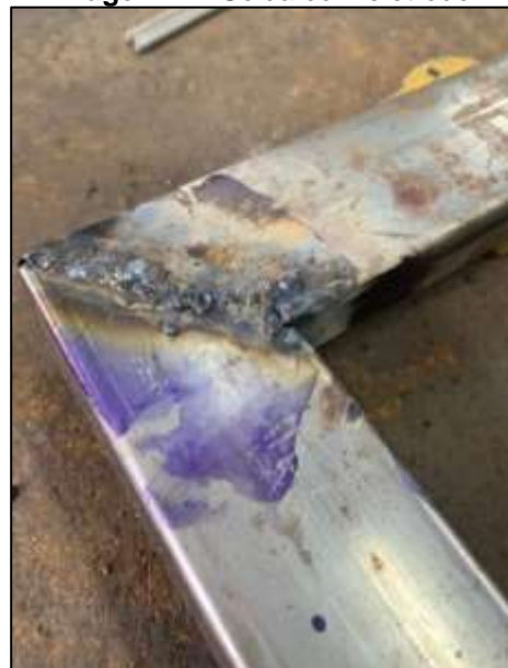
Imagem 11: Solda com eletrodo
