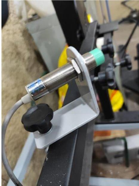
**Figura 3** – Sensor capacitivo
