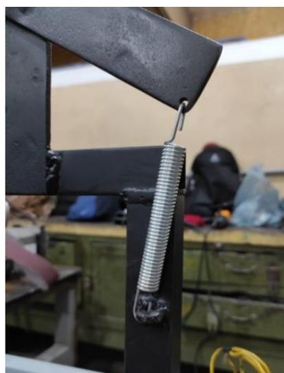
**Figura 7 – mola de tensionamento**
