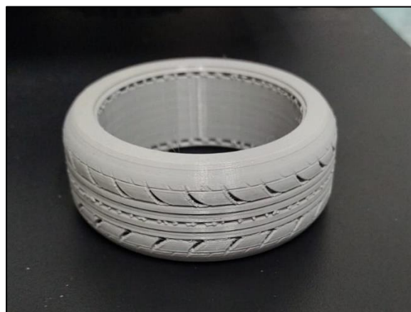
Figura 3.7 - Pneus feito na impressora 3D
