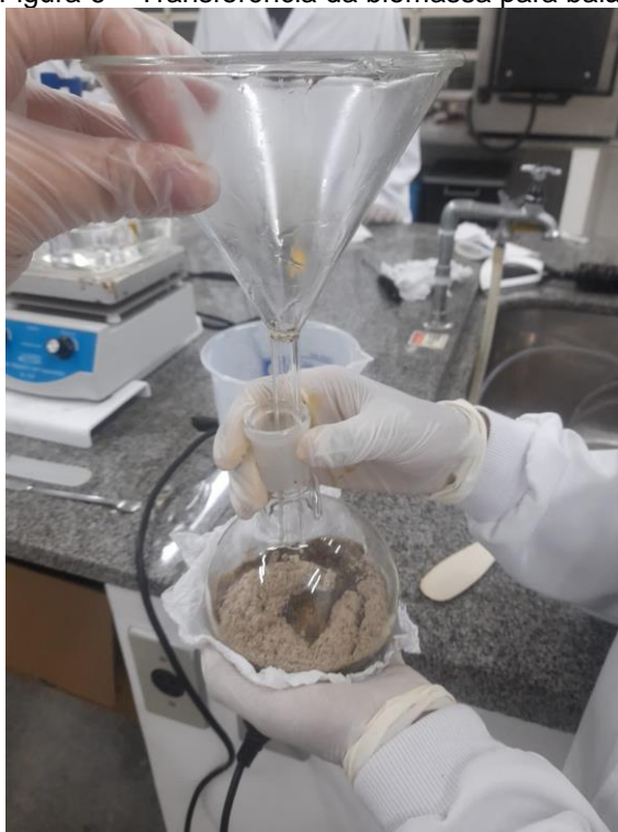
Figura 6 – Transferência da biomassa para balão
