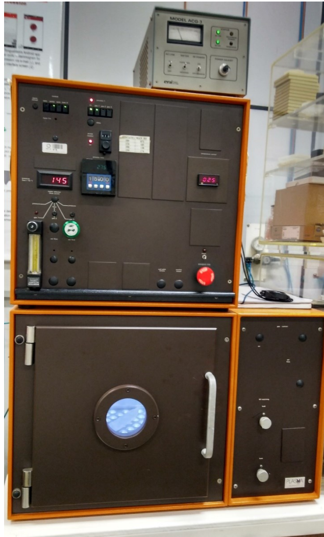
Foto 12 - Equipamento gerador de plasma
