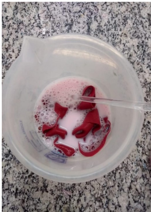
Foto 16 - Tecido no banho da solução de fluorcarbono.
