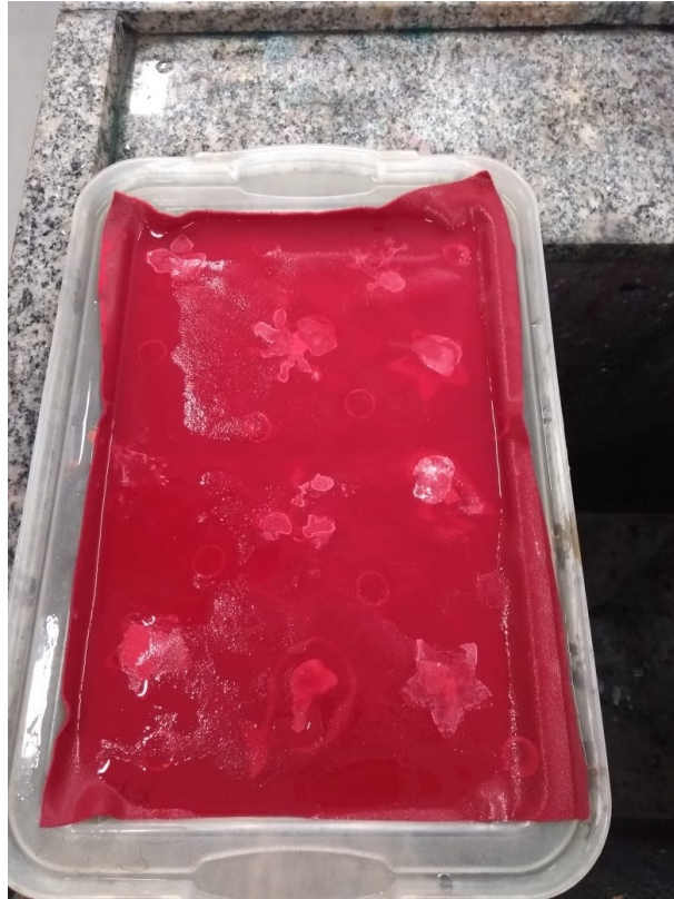
Foto 24 - Amostra onde os adesivos foram colados com cola branca
