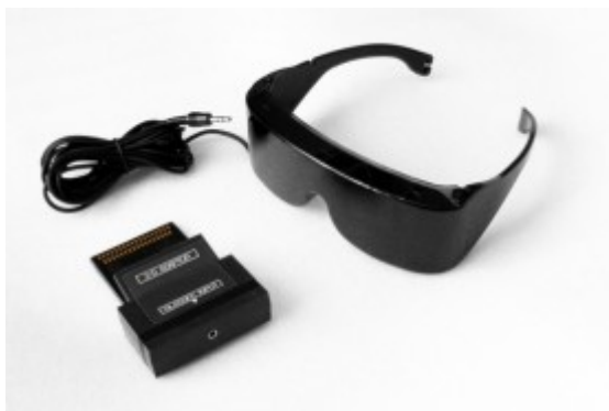
Figura 2.4: Óculos 3D Sega Scope e adaptador para o Master System I [ELDRED, 2010]
