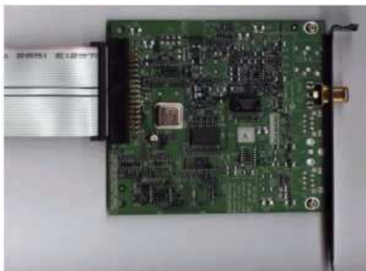
Figura 15. Placa de Som MX300 para PC da Monster Sound (MORIMOTO, 2007).
