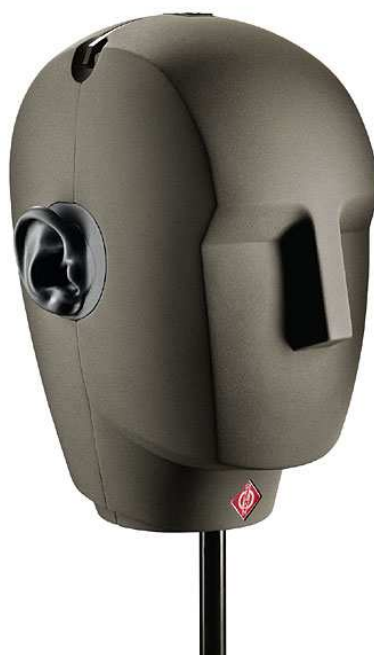
Figura 4. Manequim Neumann utilizado para gravação binaural (PORTALXBOX, 2010).
