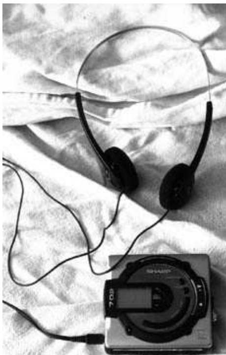
Figura 9. Adaptação de um fone de ouvido para microfone para gravação binaural (SIMON, SD).
