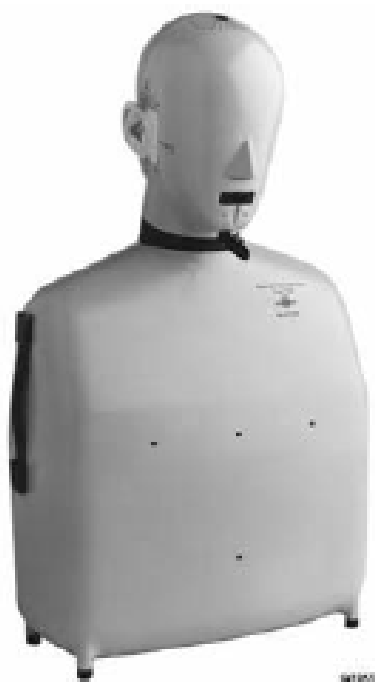
Figura 6. Simulador de tronco e cabeça, HATS (RUMSEY, McCORMICK, 2009).
