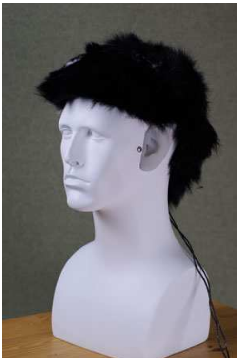
Figura 13. Manequim finalizado após adaptação para realizar gravações de áudio 3D (ANDERSON, SD).
