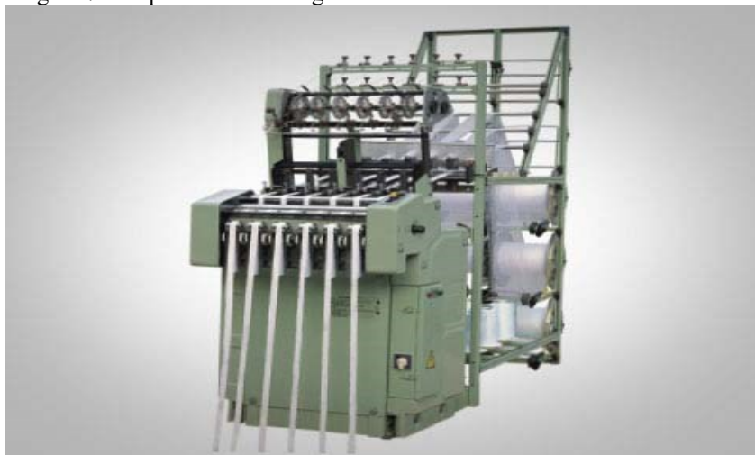
Figura 7: Máquina de tear de agulha ilustrativa
