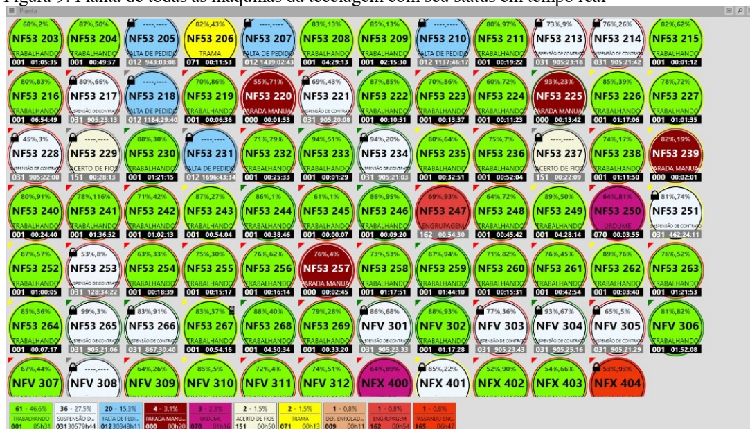
Figura 9: Planta de todas as máquinas da tecelagem com seu status em tempo real
