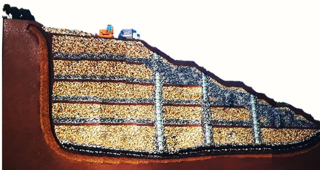
Figura 2 – Tratamento dos RSD: Aterro Sanitário
