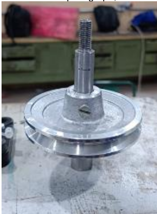
Figura 6- Eixo torneado pelo grupo, rosca M10x1,5mm
