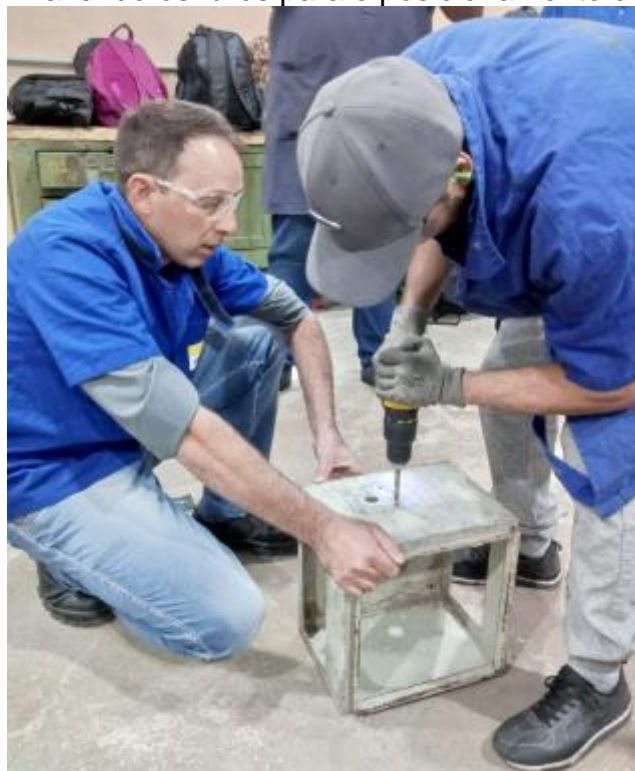
Figura 9- Fazendo os furos para o posicionamento do mancal.
