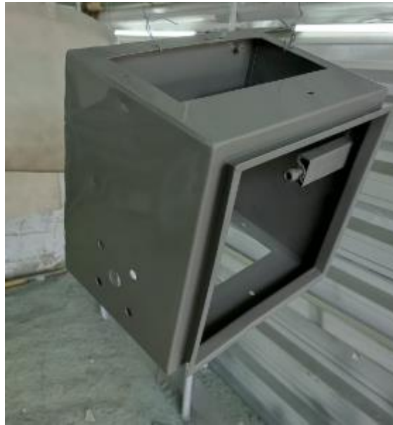
Figura 8 - Pintura da caixa onde será instalado o motor e o disco
