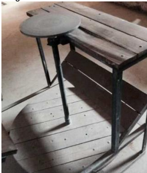
Figura 1- Torno de oleiro manual.
