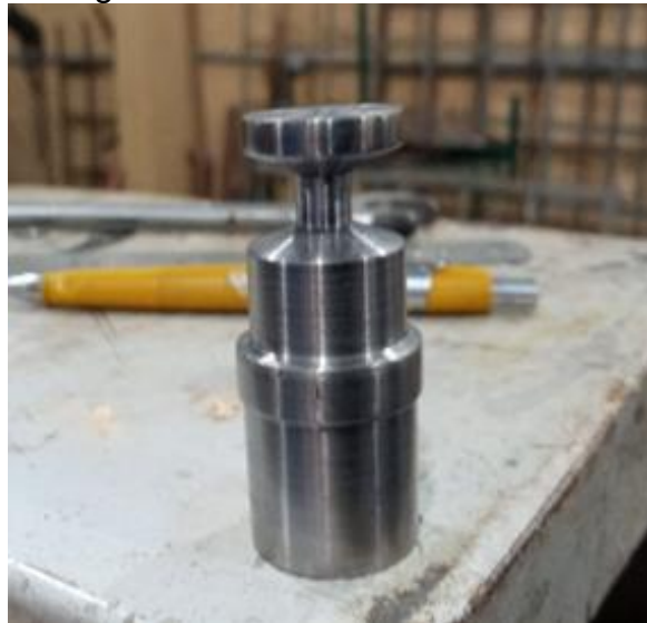
Figura 4- Polia de 20mm usinada.
