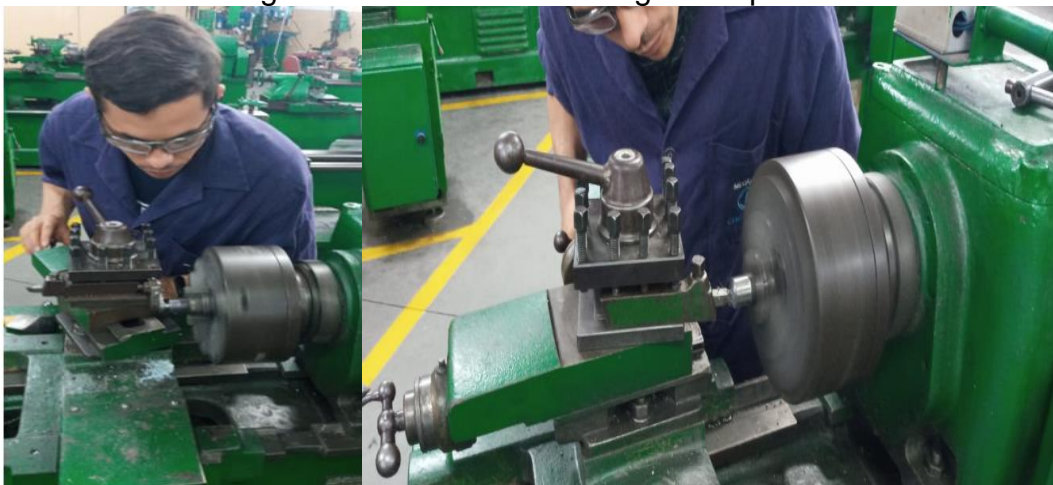
Figura 3- Processo de usinagem da polia.
