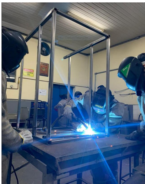
Imagem 12 – Soldagem da estrutura
