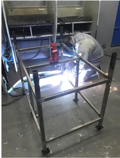
Imagem 15 – Soldagem das rodas giratórias
