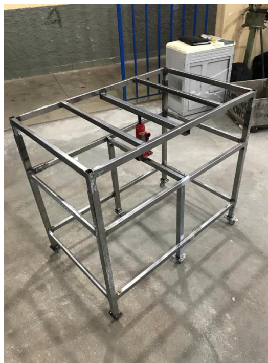
Imagem 16 – Estrutura da Bancada Elevatória Hidráulica
