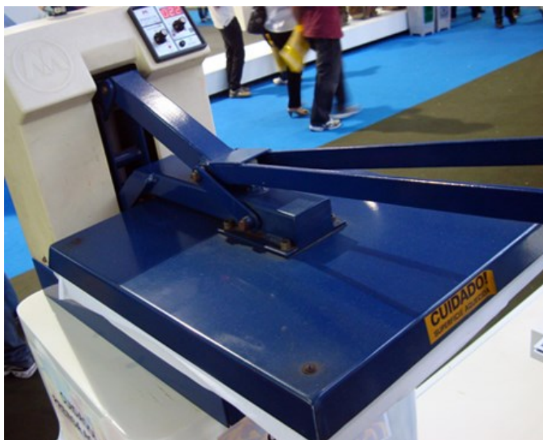
Figura 52: Prensa térmica aquecida em processo de sublimação
