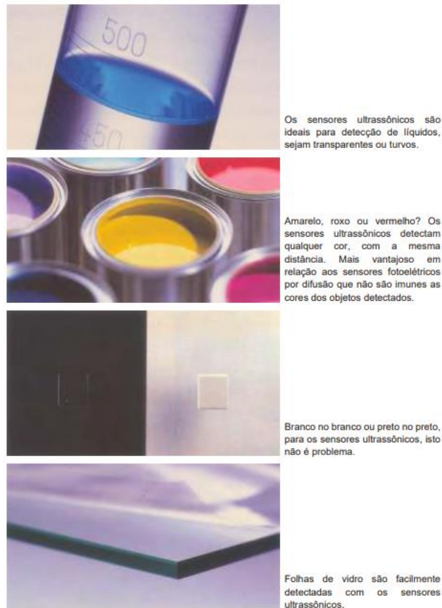
FIGURA 2: MATERIAIS DETECTADOS PELOS SENSORES ULTRASSÔNICOS
