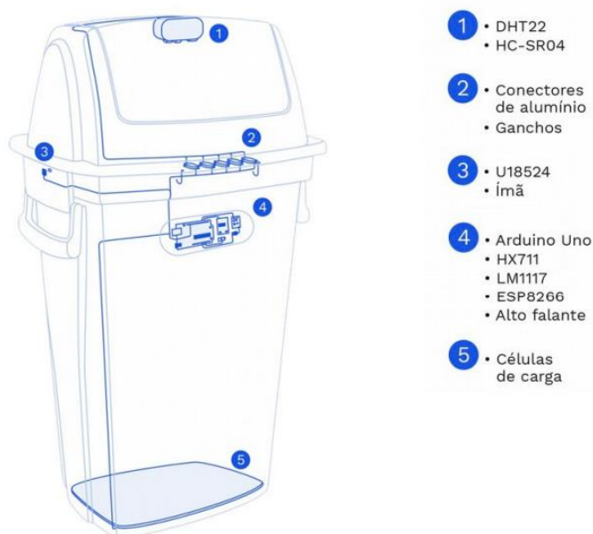
FIGURA 3: COMPONENTES DO PROTÓTIPO DA LIXEIRA INTELIGENTE
