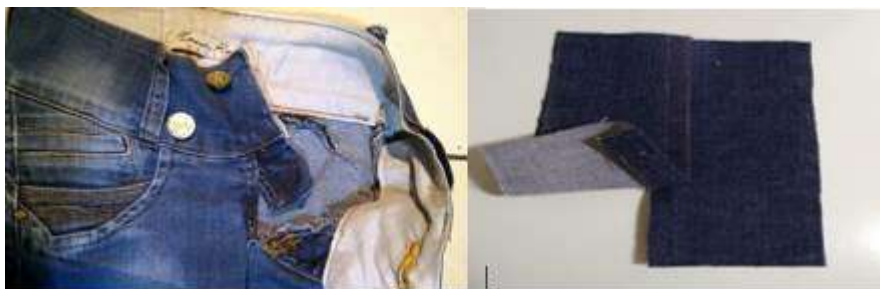
Figura 41 – Modelo de costura colocação de vista
