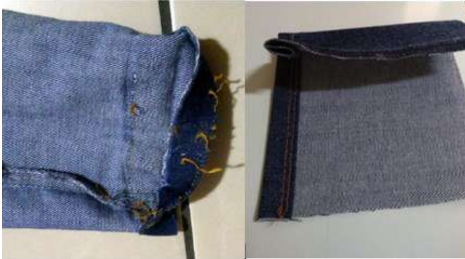
Figura 37 – Modelo da costura da barra simples
