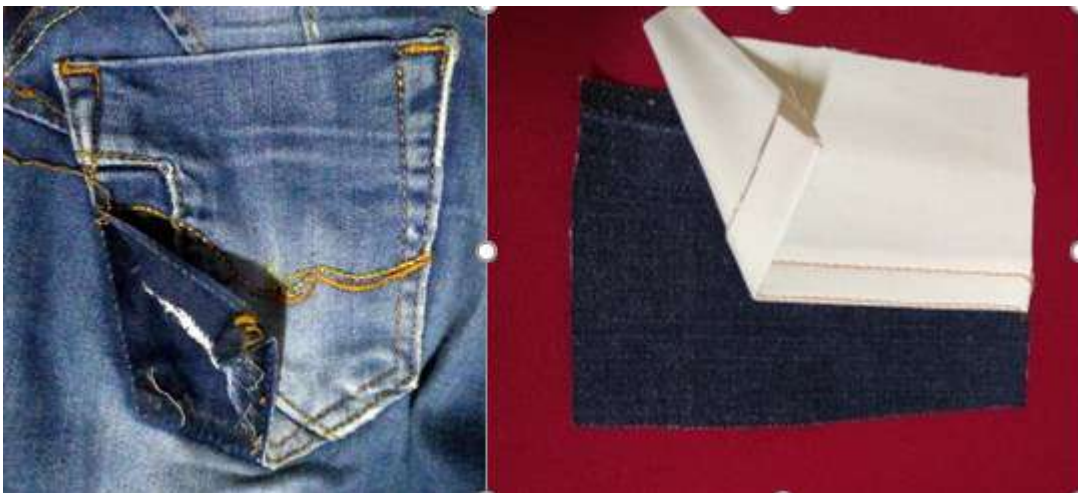
Figura 45 – Modelo da costura de colocação de bolso
