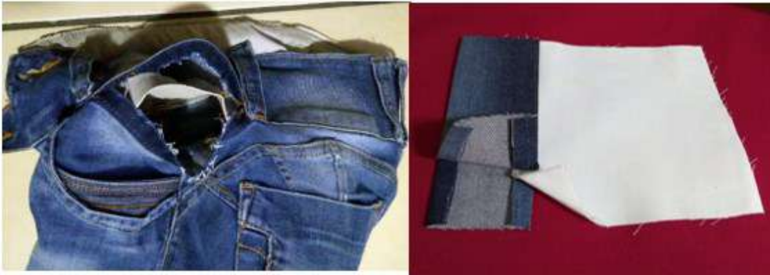
Figura 39 – Modelo costura junção do cós e o corpo
