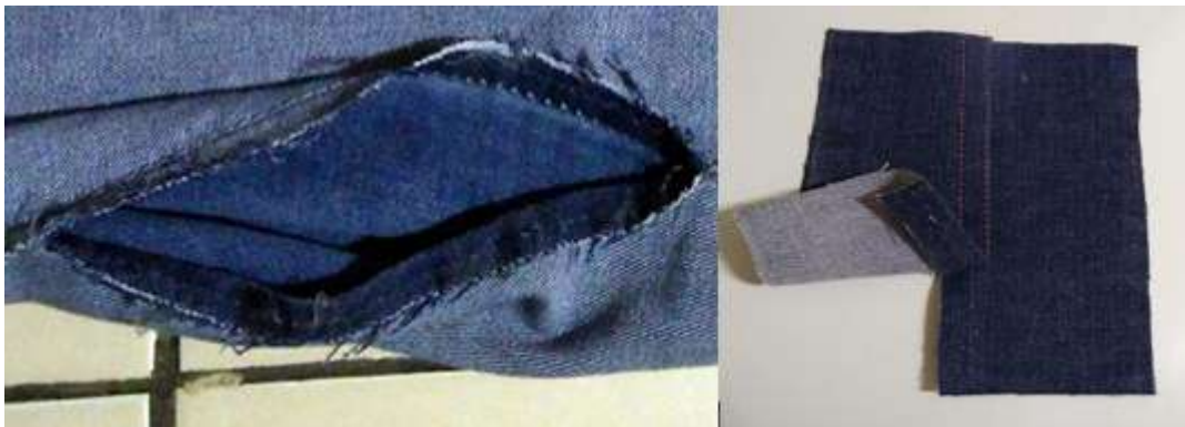
Figura 43 – Modelo da costura do fechamento lateral
