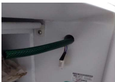
Figura 9 – Sensor DHT22 instalado na estufa
