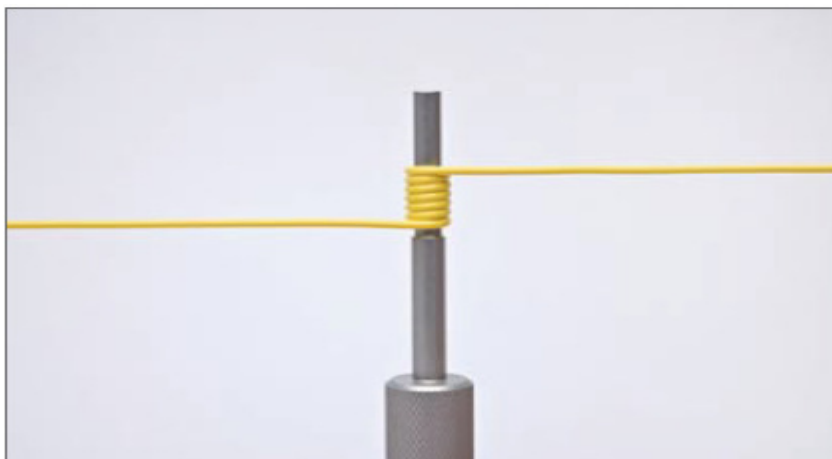
Figura 8 – Cabo Drop compacto de 2,9 mm
