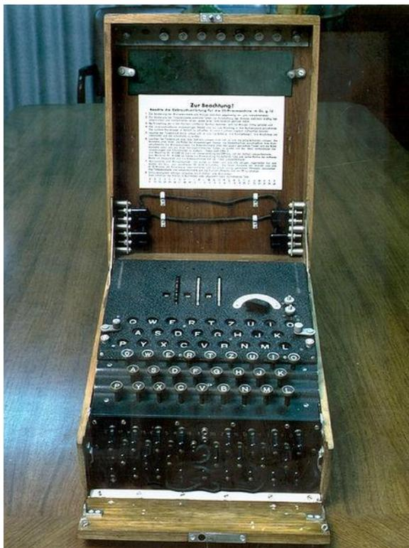
Figura 2 - Máquina Enigma com três rotores, teclado, luzes e conexões. (Ellsbury, 1998)
