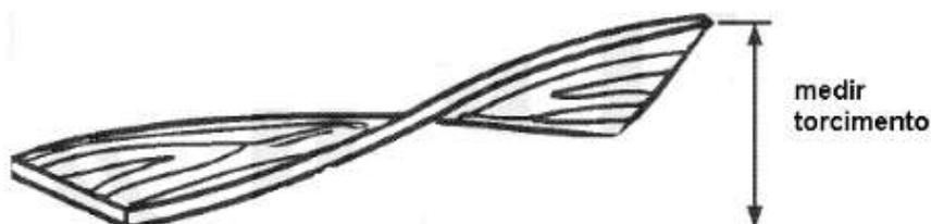
Figura A.9 – Medição do torcimento
