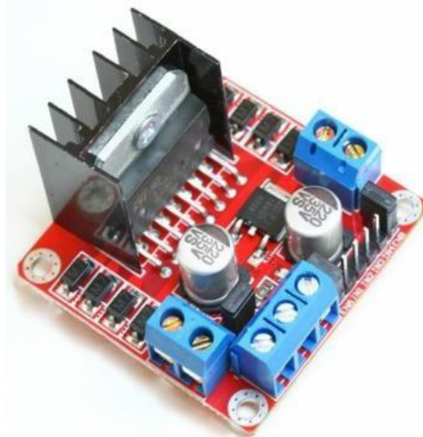
Figura – Ponte H embarcada L298N para a movimentação horizontal
