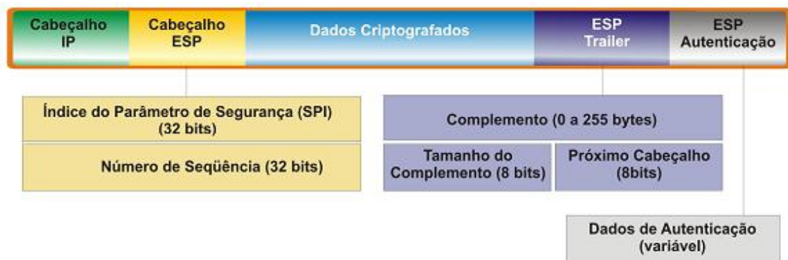
Figura 14: Estrutura do ESP
