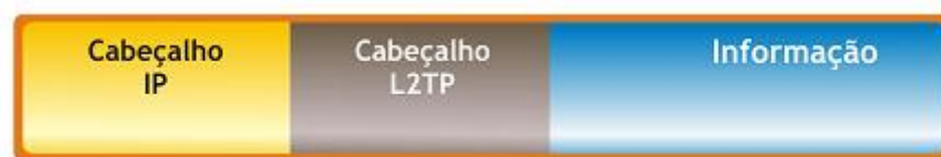
Figura 10: Visão do Encapsulamento L2TP
