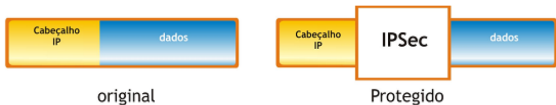
Figura 11: Encapsulamento IPSec no modo transporte
