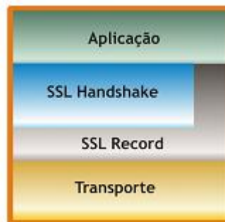
Figura 15: Estrutura das camadas do Protocolo SSL/TLS
